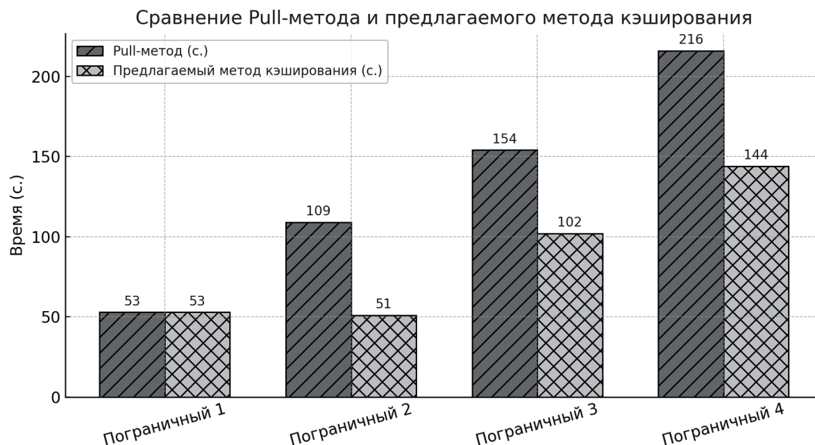
Рис. 5. Результаты эксперимента внедрения в CDN метода кэширования на основе нечеткой логики
