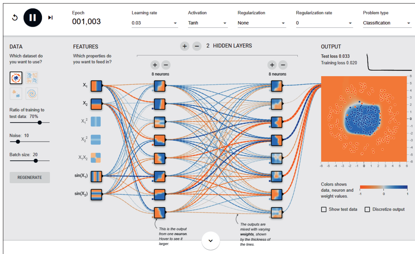
Рис. 2. Скриншот работы программы TensorFlow. Архитектура нейросети после 1000 циклов обучения
