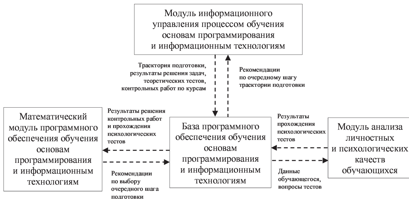
Рис. 2. Структурная схема элементов программного комплекса SkillsForYou, используемых для выбора вида деятельности ИТ-специалиста и обучения основам программирования
