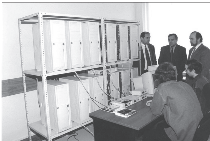
Фото 2. Первый вычислительный кластер ВЦ МГУ в 1999 году объединял 18 процессоров Intel Pentium III. На фотографии — расширенный 24-процессорный вариант (источник фото: http://parallel.ru/cluster/photo_history.html )
