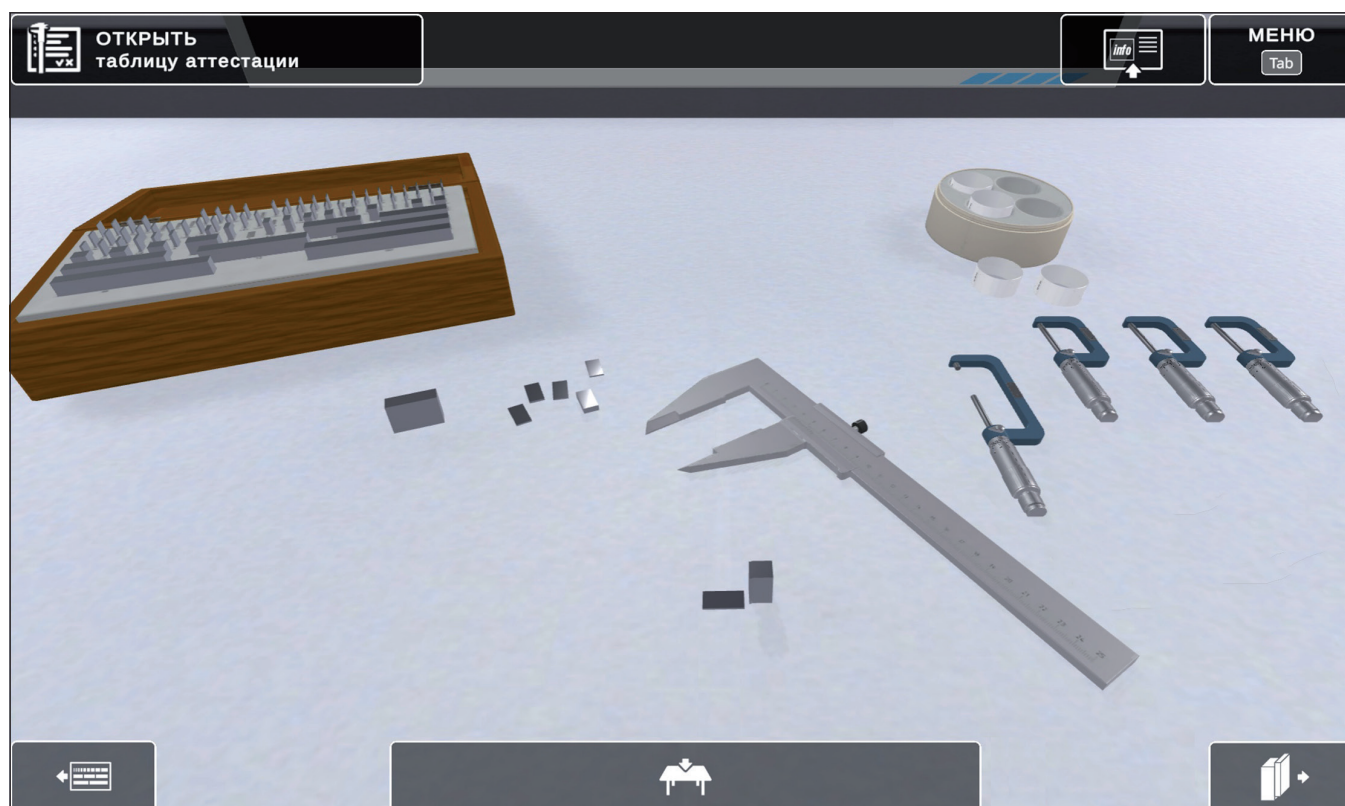
Рис. 5. Рабочая зона с штангенциркулями, микрометрами и концевыми мерами
