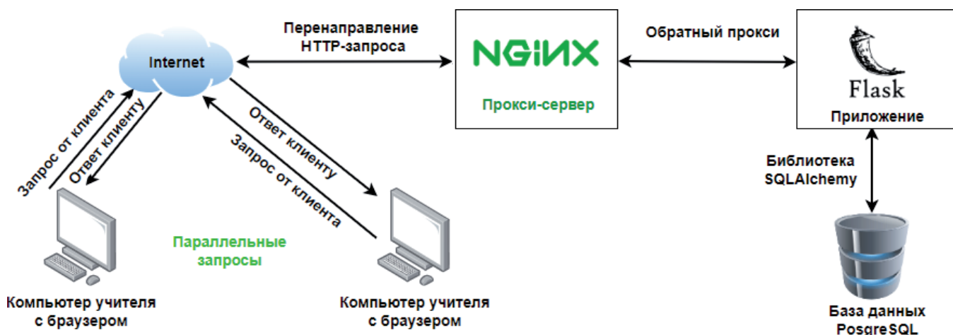
Рис. 3. Схема взаимодействия контейнеров программного модуля
